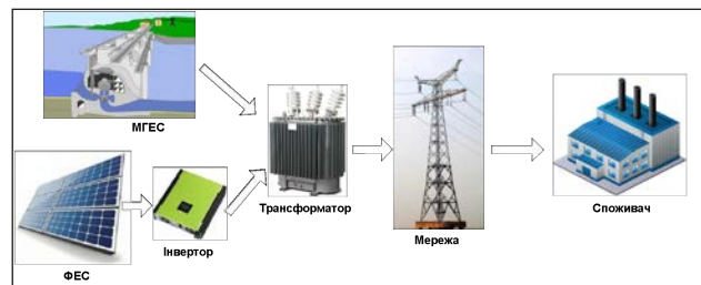
Рис. 3. Структурна схема сумісної роботи ФЕС та МГЕС у локальній ЕС
